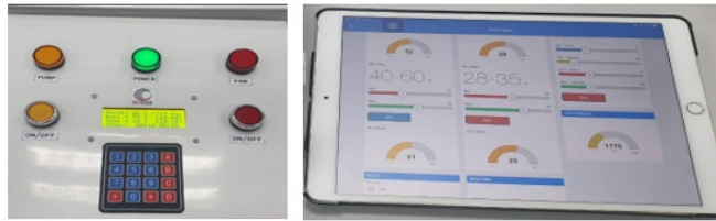
รูปที่ 2 ระบบสั่งการและการมอนิเตอร์ผล สามารถสั่งการได้ทั้งหน้าตู้ควบคุมและหน้าจอมือถือ
